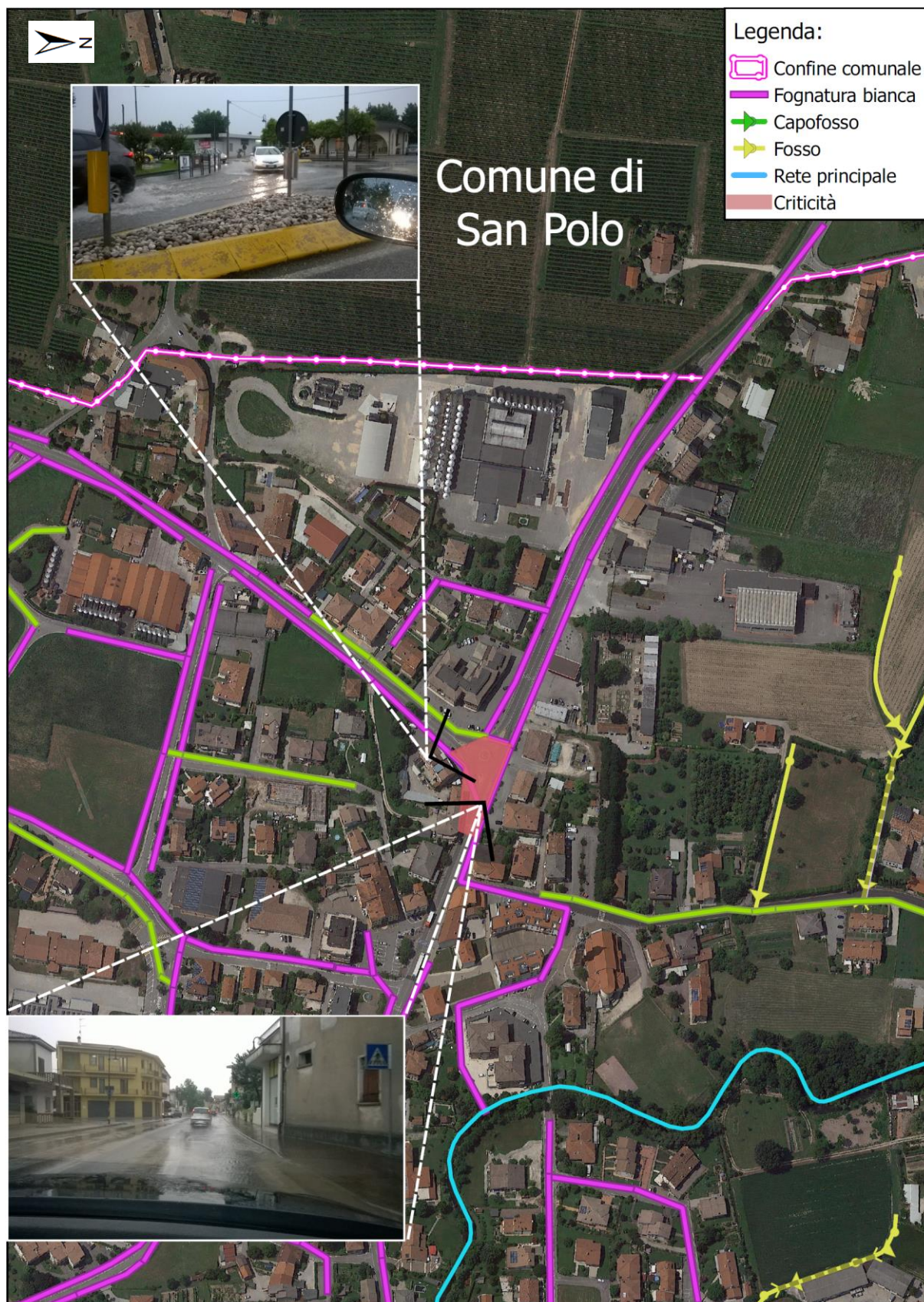
Figura 6.2: Insufficienza idraulica all'incrocio tra la Strada Provinciale 43, via Roma e via G. Pascoli
