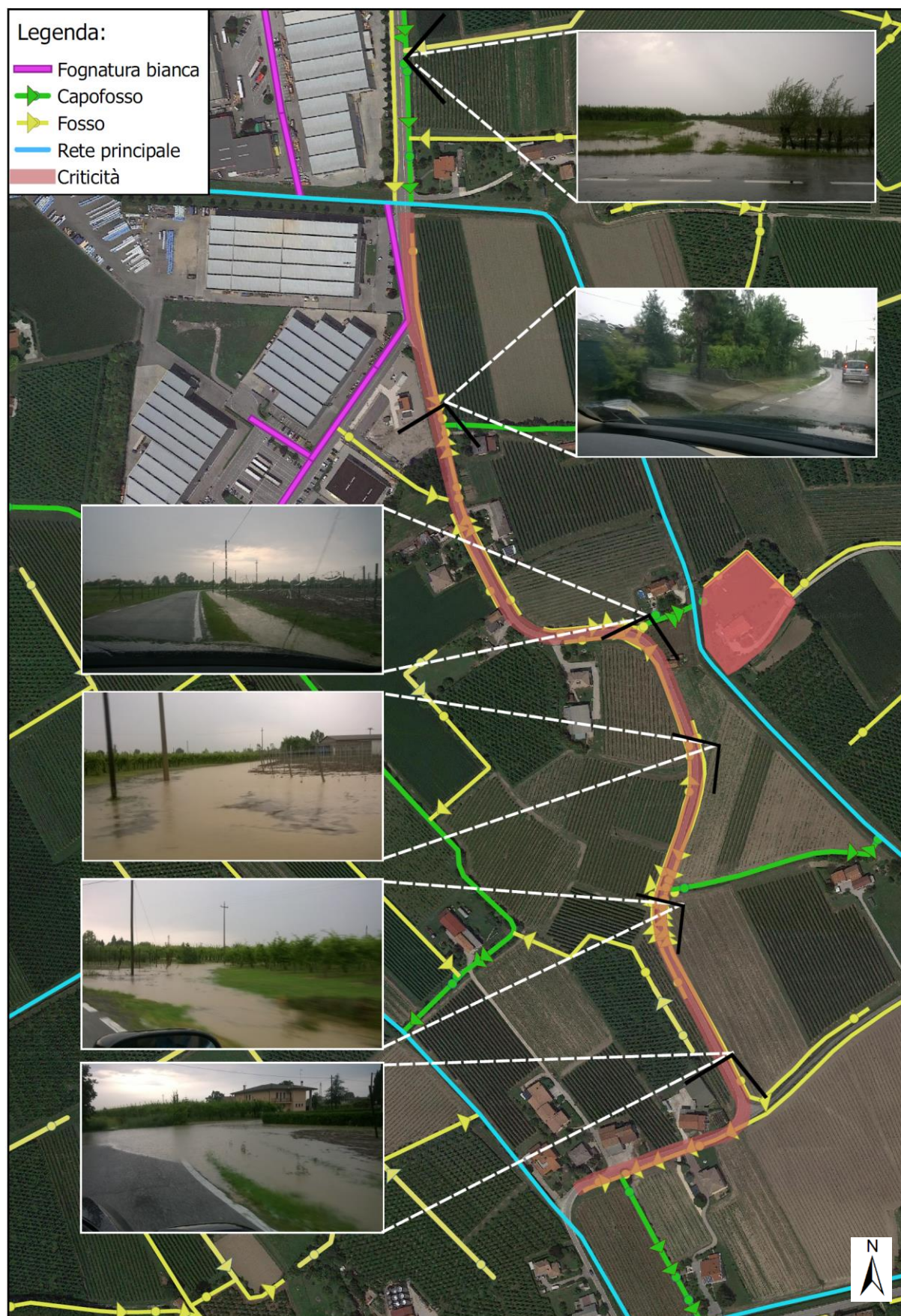
Figura 6.3: Insufficienza idraulica di via Trattori
