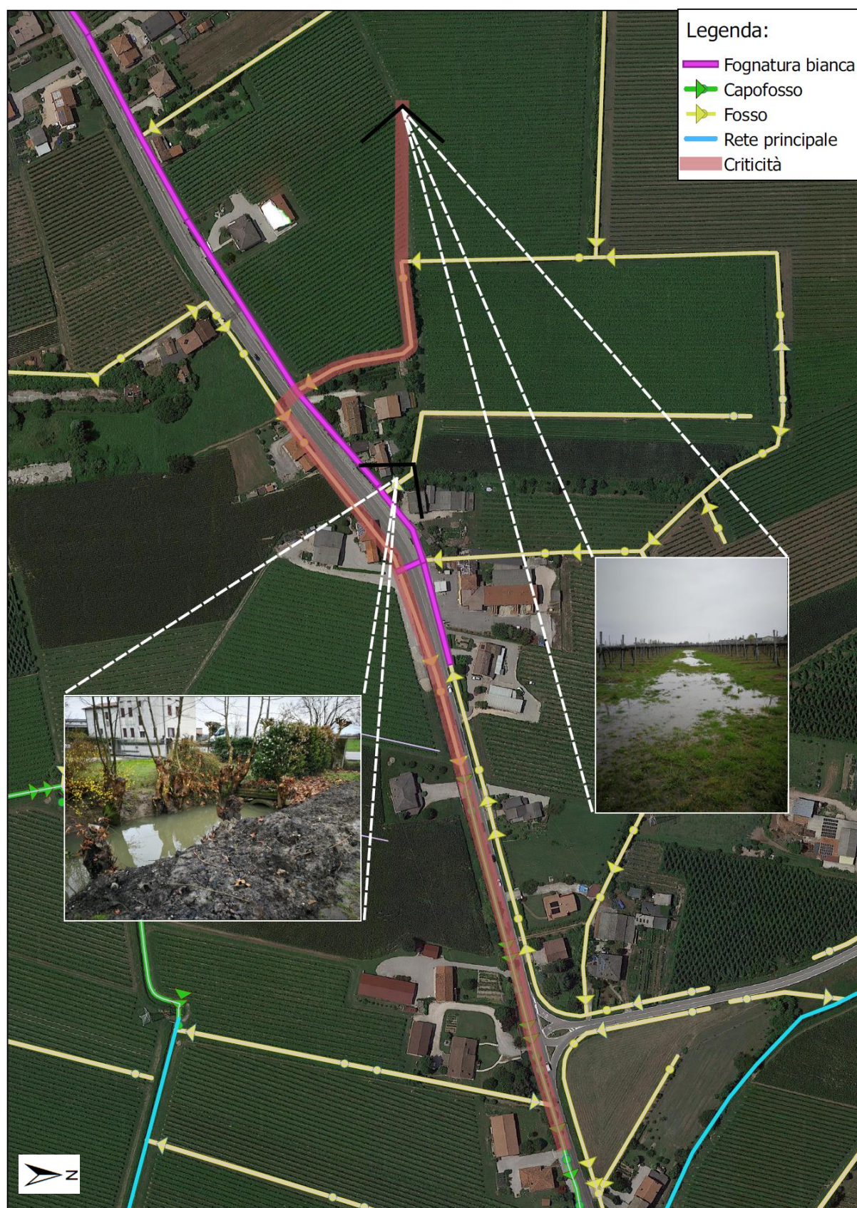
Figura 6.1: Insufficienza idraulica in via Roma
